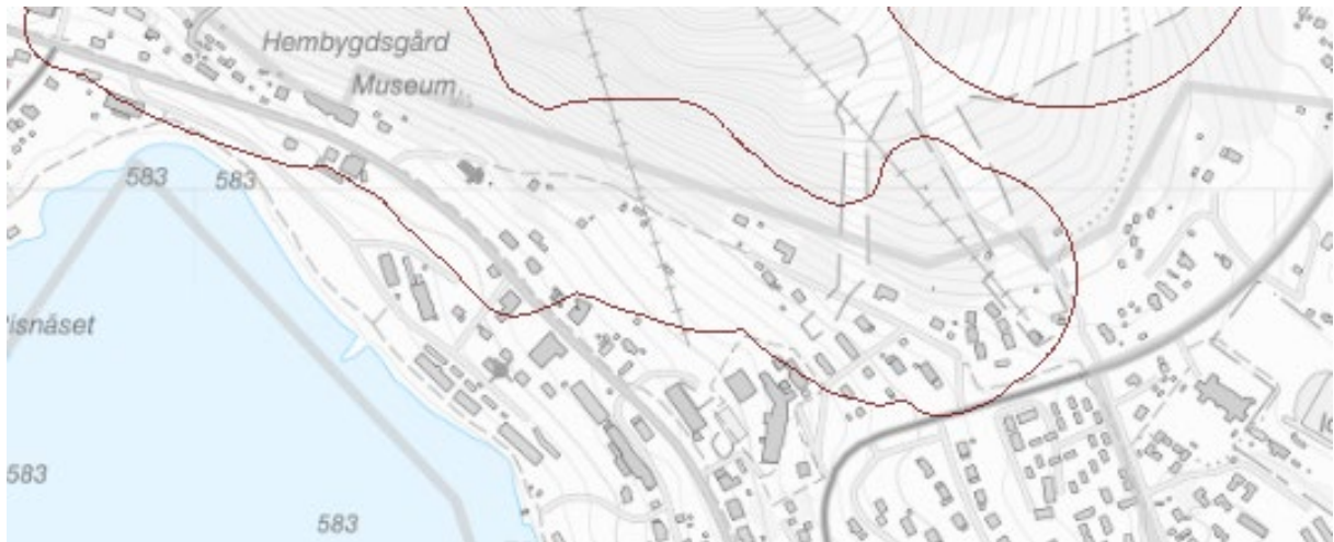
Figur 39 Område som kan påverkas vid ras inringat med mörkbrunt (Skogsstyrelsen).
