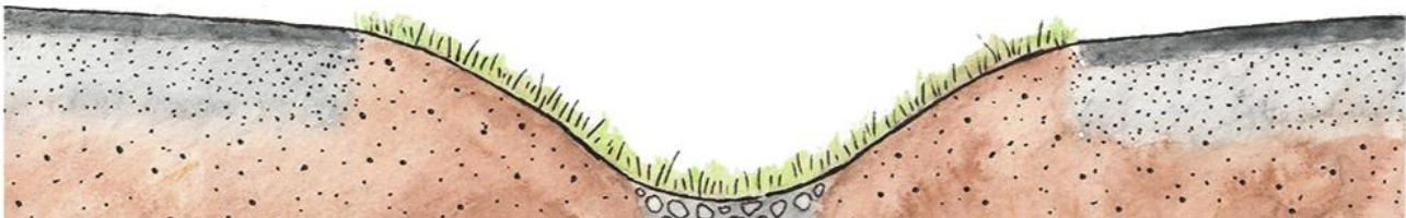
Figur 12. Illustration dike med kross i dikesbotten. VA-guiden
